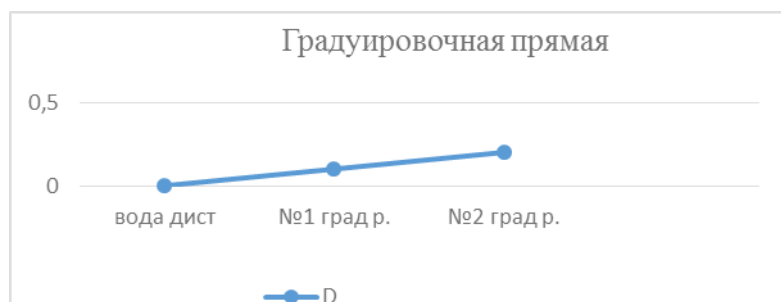
Рис 3. Полученные значения оптической плотности для построения градуировочного (калибровочного) графика.
