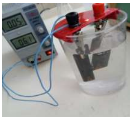
Рис 3. Индикатор электрического тока (горит лампочка) в растворе поваренной соли
