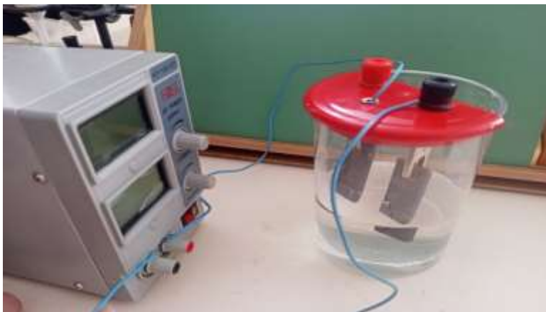
Рис 2. Изучение проводимости электрического тока поваренной соли
